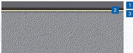
Figur C.6.5 Avretting på Leca Byggeplank.
