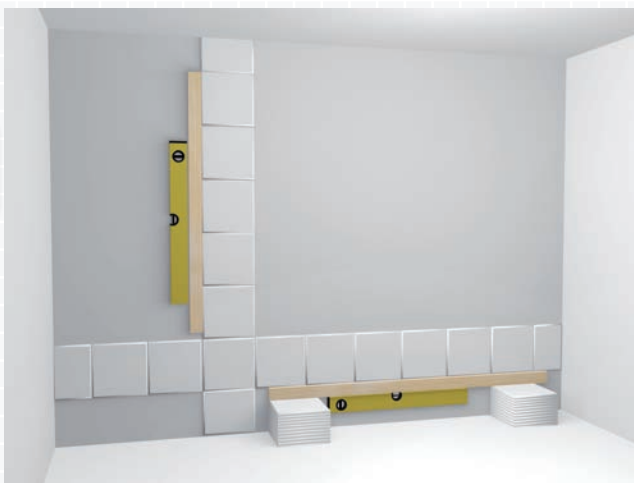
Figur E.9.1 Flislegging på vegg.
