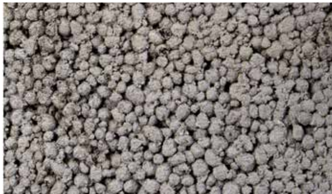
Figur 3.6 Porøsitet i Leca lettklinkerbetong
