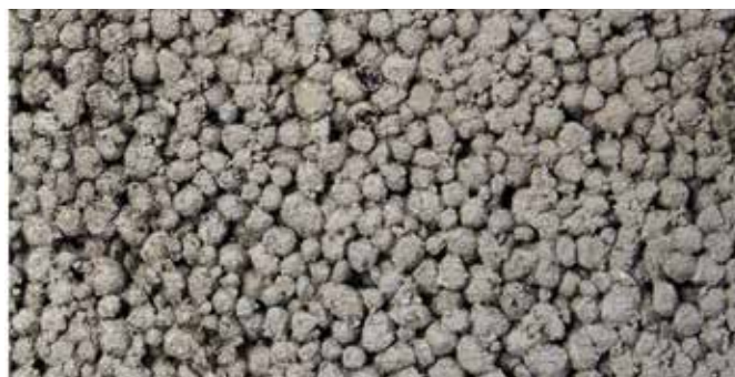
Figur 3.6 Porøsitet i Leca lettklinkerbetong
