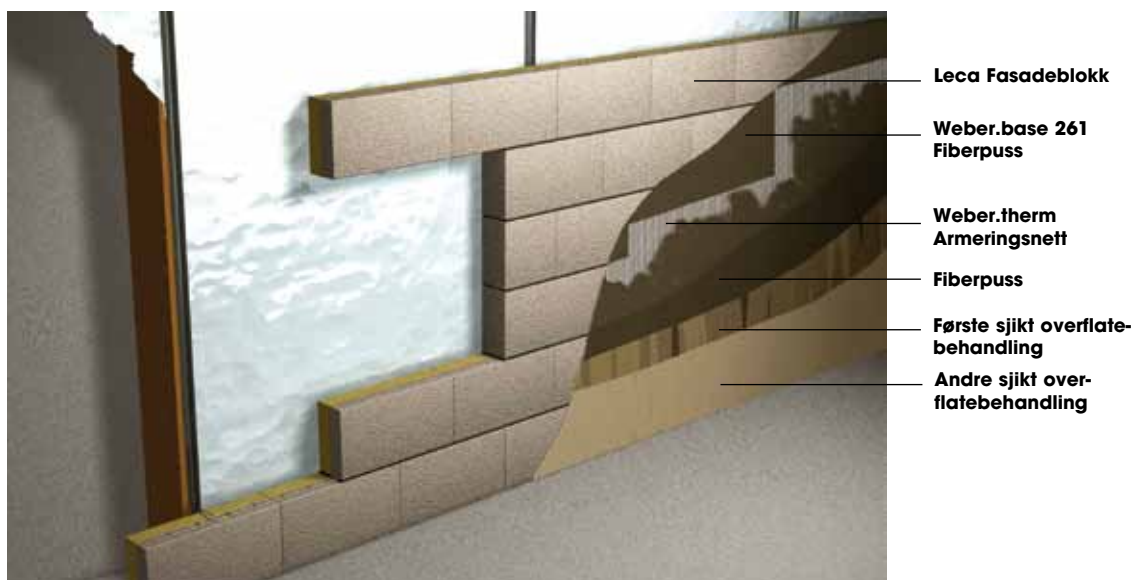
Figur 2: Weber Fiberpuss system. Eneste anbefalte pussløsning utvendig på alle Leca blokker.
