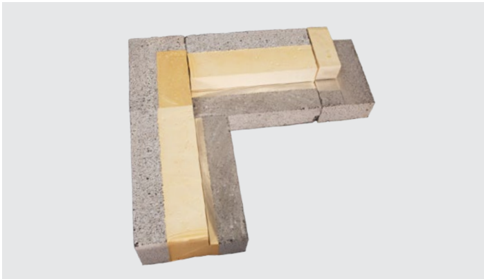
Leca Ringmur 35 cm. Øverste skift tilpasset for gulvstøp og plastfolie/ radonmembran – utvendig og innvendig hjørne.
