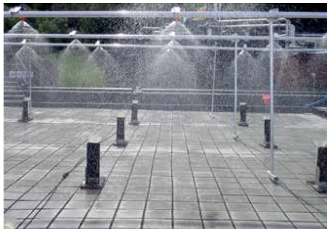
Klima 2050 fokuserer på løsninger med høy kapasitet på vannfordrøyning, og er i stand til å kjøre ekstreme tester. Her testes vannfordrøyning i en permeabel flate med en underlag av knust Leca. Foto: Tore Kvande, NTNU
