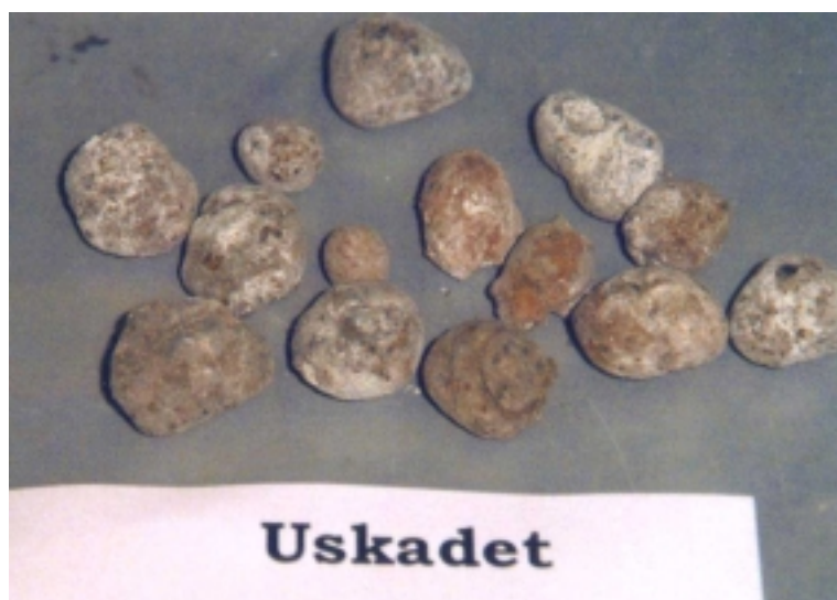
Figur 4.2 Eksempel på uskadet Leca etter innbyggingsforsøk.
